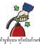
3 : กดหัวบีบขึ้นบน หรือบีบที่ปุ่มด้านข้างเพื่อทำการฉีดสารออกมา
