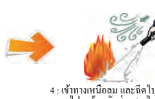
4 : เข้าทางเหนือลม และฉีดไปที่ฐานของไฟ พร้อมกับส่ายสายไปมาซ้ายขวา
